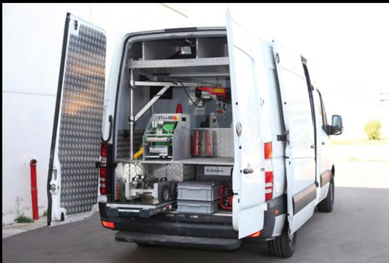
Dispone di una unità mobile integrata per indagini videoispettive fognarie dotata di una unità Pipe Cruiser che garantisce ispezioni dettagliate per una larga gamma di diametri che va dal DN 150 al DN 1500.
